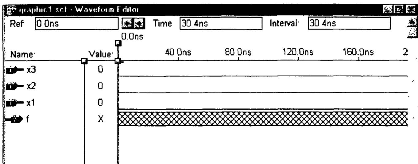
Рис. 5.5. Вид окна редактора диаграмм (определены входные и выходные линии и сетка)
