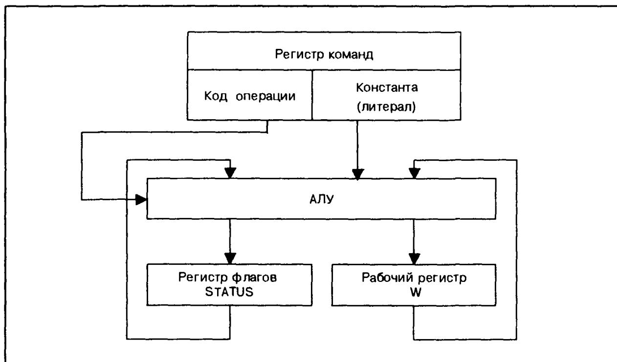
Рис. 5.13. Структура устройства на основе регистрового АЛУ
