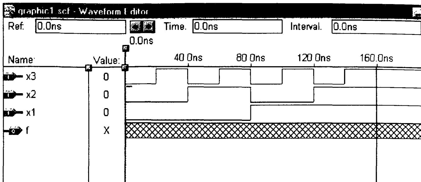
Рис. 5.6. Окно редактора диаграмм с определенными для симуляции диаграммами входных переменных
